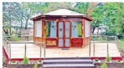
भोपाल के सीएसआइआर-एम्प्री परिसर में बहोर परिकल्पना बांस कम्पोजिट से बनाया गया बहुस्तरीय संरचना। © सम्प्री खोज का फोरेट कर किया गया है और इस तकनीक को मेसर्स पर्यायित वास्तविक विनिर्देश कंपनी, भोपाल को स्पान्सरशिप किया गया है, ताकि अने जाने समय में इन इस्तेमाल करके बनाए जा सकें।
