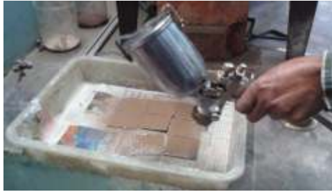
स्प्रे-गन द्वारा माइल्ड स्टील की प्लेटों पर फोस्फटिक जियोपॉलीमरिक कोटिंग
