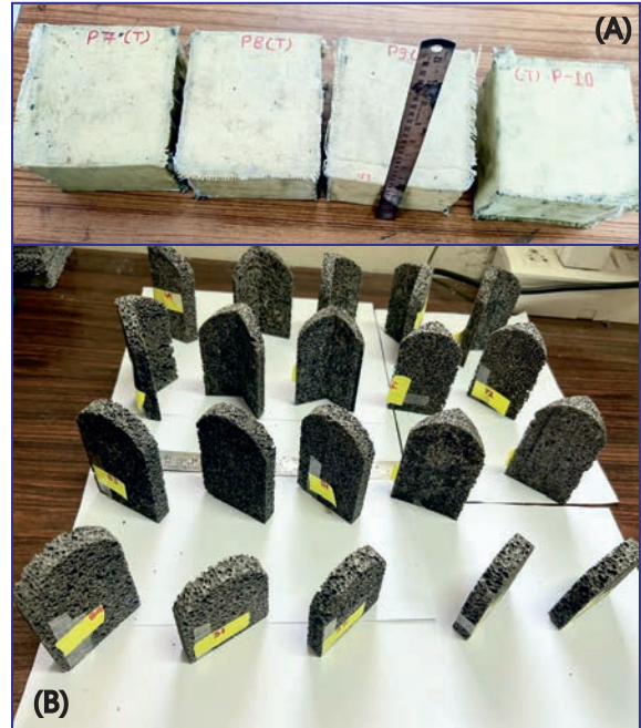
(ए) एल्युमीनियम हाइब्रिड कम्पोजिट फोम कोर सैंडविच संरचनाएं (बी) ब्लास्ट परीक्षण और मूल्यांकन के लिए बूट-एंटीमाइन प्रोटोटाइप के साथ इकट्ठा की जाने वाली वायर ईडीएम मशीनीकृत एल्युमीनियम हाइब्रिड कम्पोजिट फोम संरचनाएं
