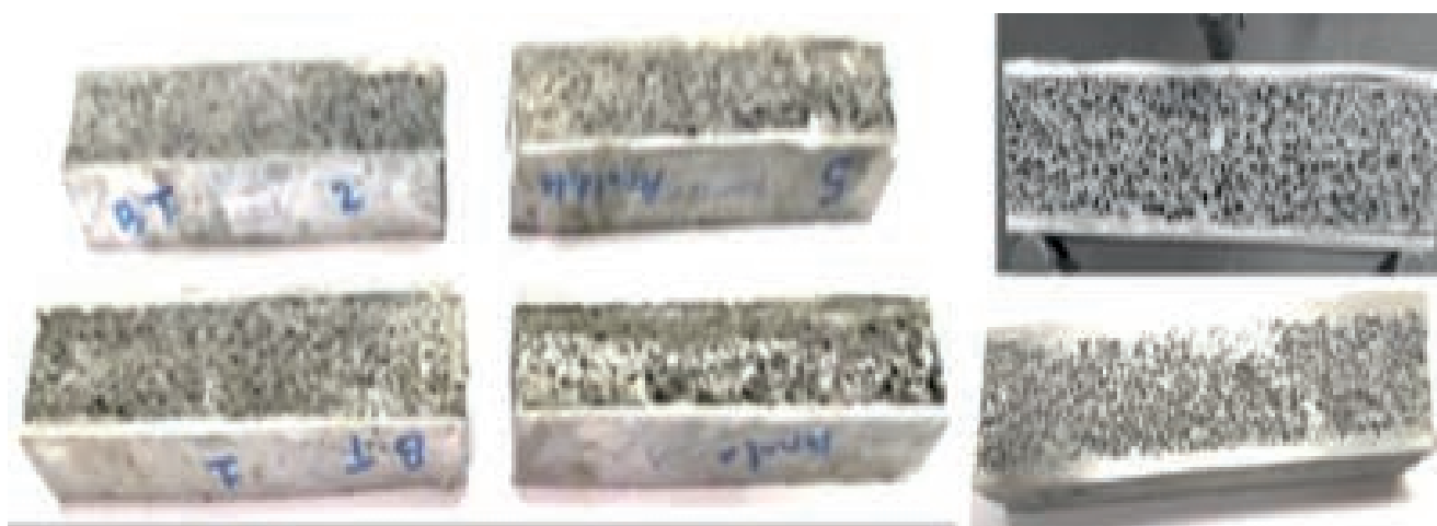
चित्र 8 मेटैलिक फोम इन-फिल्ड सैंडविच कंपोनेंट के आनमन नमूने
