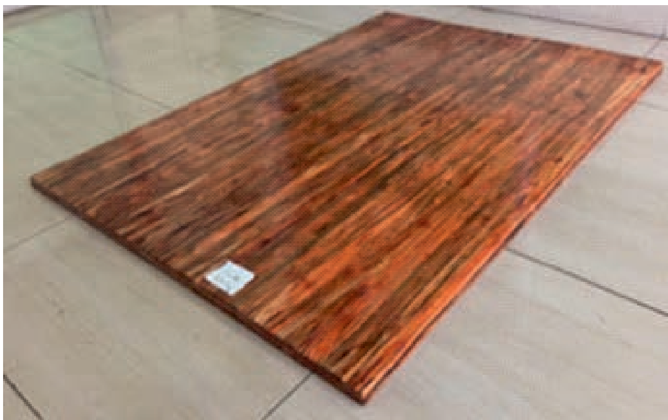
चित्र 2 औद्योगिक प्रक्रिया मशीनरी का उपयोग करते हुए 1200 मिमी x 900 मिमी के आकार का बम्बू कम्पोजिट का एक पैनल
