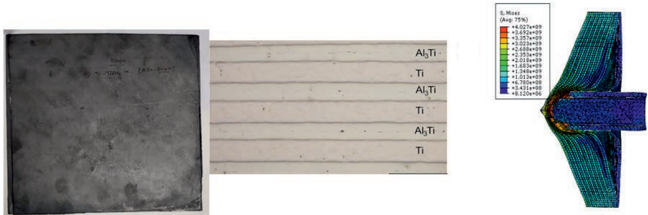
चित्र 22 (a): मल्टीलेयर लैमिनेट्स और 8 मिमी आर्मर प्लेट्स (200 मिमी * 200 मिमी) का योजनाबद्ध चित्रण (b): एमएससी एनआईजे III + 7.62 * 39 मिमी बुलेट के साथ 8 मिमी Ti-TiAl 3 मल्टी-लेयर प्लेट्स का अनुकरण
