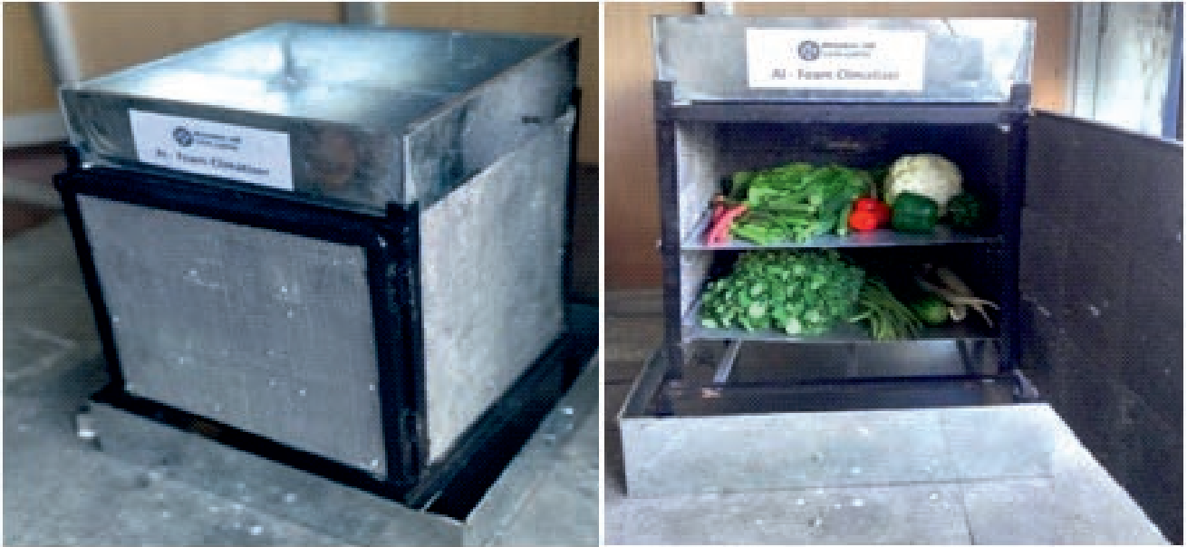
चित्र 19 एल्युमीनियम फोम का उपयोग करके सीएसआईआर-एम्प्री में निर्मित रूरल क्लाइमेटाइज़र
