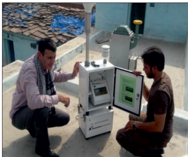
चिह्नित लोकेशन AAQM पर उपकरण की स्थापना
