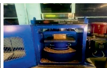
रेड मड – फ्लाई ऐश जिओपोलिमरिक बाइंडर की दाब शक्ति का मूल्यांकन
